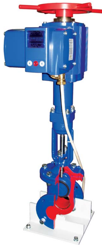
Рис. 3. Опытный образец безредукторного многооборотного электропривода типа А
